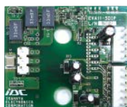
Super mini DIIPM™ evaluation board EVA11-SDIP
